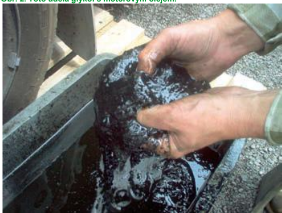
Obr. 2. Toto udělá glykol s motorovým olejem.
